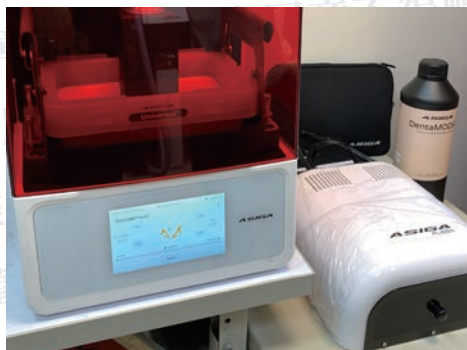
Asiga 會在列印過程即時監測並持續調整水平，提升列印成品的成型品質
